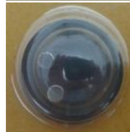
Wskaźnik po zadziałaniu pola magnetycznego o natężeniu od 120 kA/m
